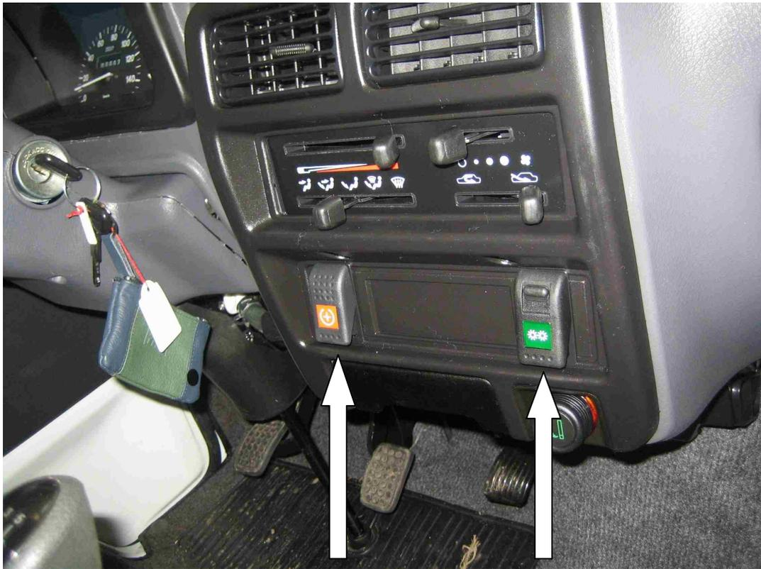
Bild 1:                      Drehzählerhöhung                      Hydraulikpumpe
